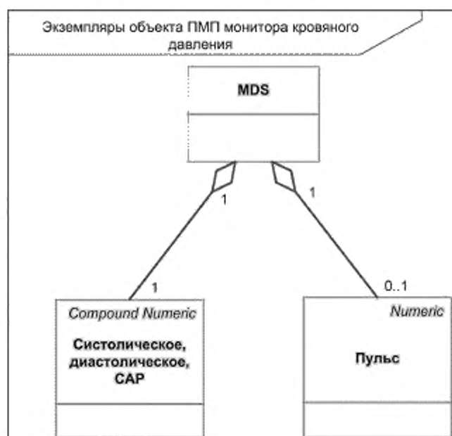
Рисунок А.1 — Модель предметной области монитора кровяного давления
