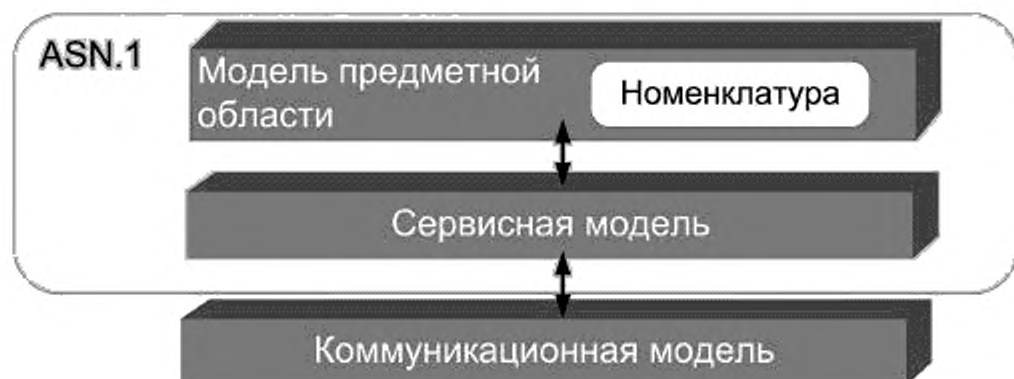
Рисунок 5 — Базовые блоки моделирования в стандарте ИСО/МЭК 11073-20601
