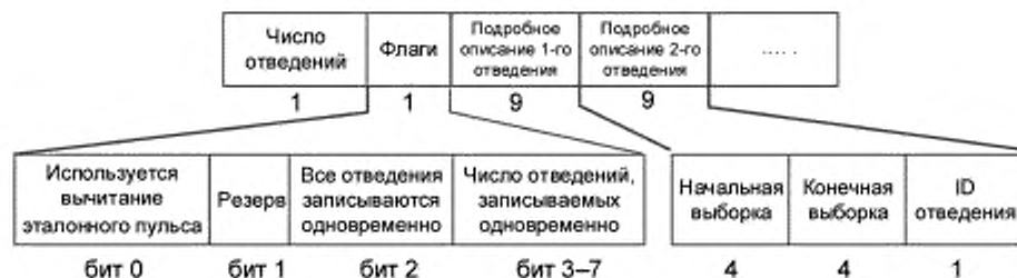
Рисунок 6 — Обзор части данных раздела определения отведения ЭКГ
