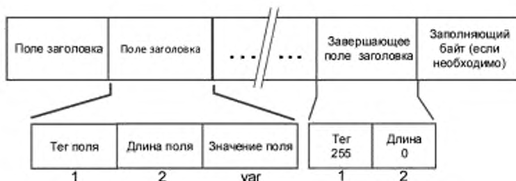
Рисунок 4 — Обзор части данных раздела «Заголовок»
