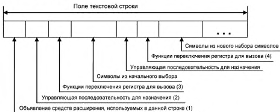
Рисунок А.5 — Структура поля текстовой строки (ИСО/МЭК 2022)
