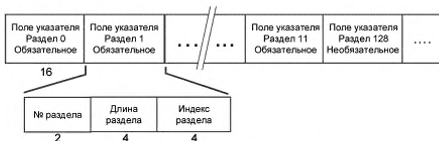
Рисунок 3 — Обзор структуры раздела указателя
