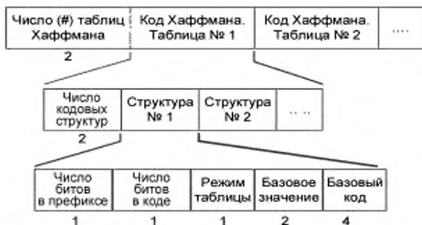
Рисунок 5 — Обзор структуры раздела таблиц Хаффмана
