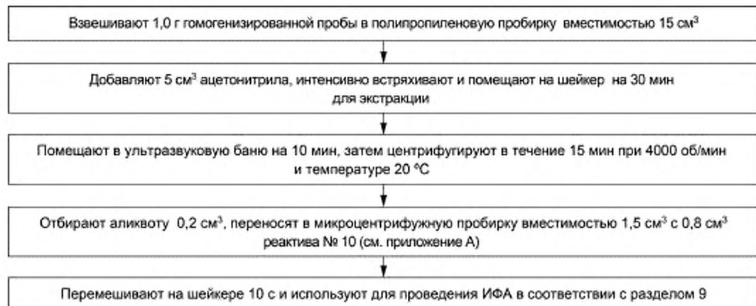
Рисунок 1 — Подготовка проб кормов, комбикормов, комбикормового сырья
