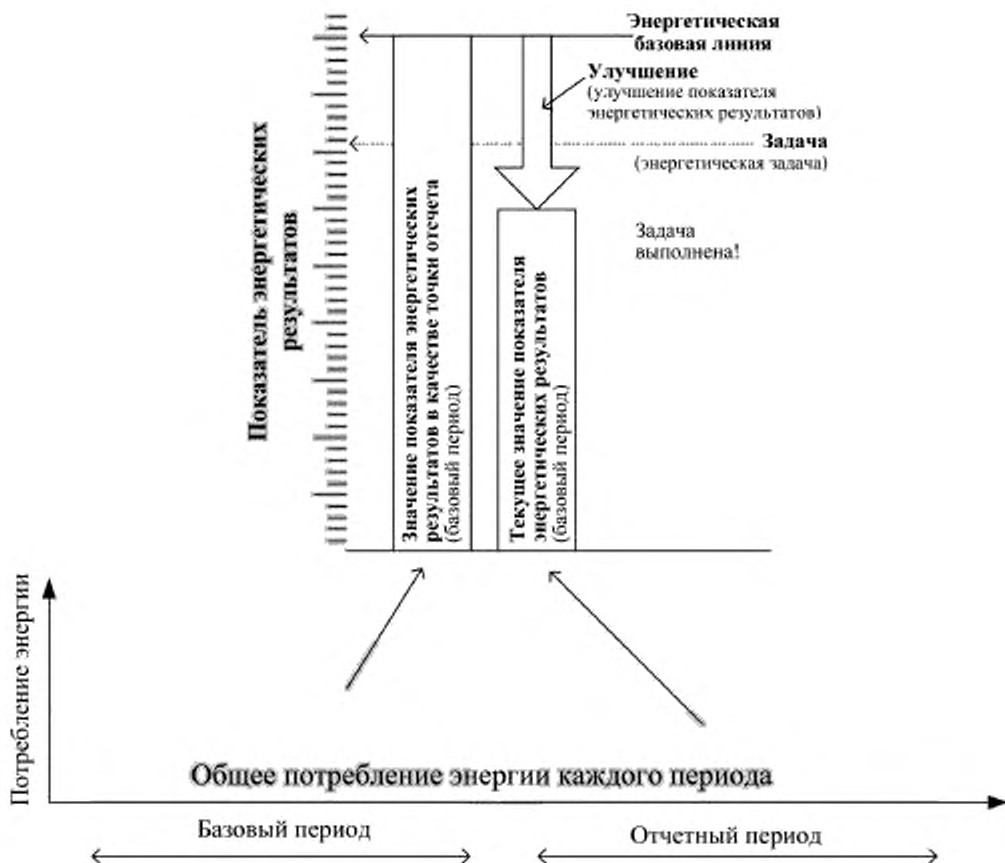
Рисунок 3 — Концепция базового периода и отчетного периода для показателя энергетических результатов
