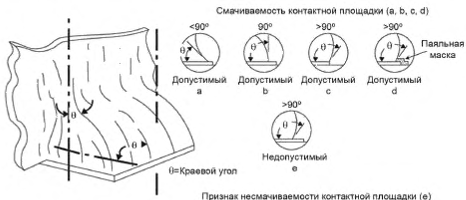
Рисунок 1 — Варианты краевого угла смачивания припоя \theta , виды состояний
