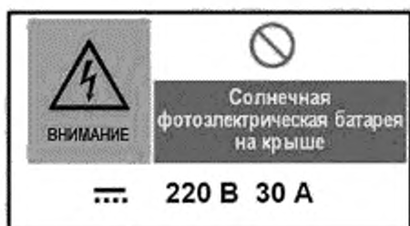
Рисунок В.6 — Пример предупреждающего знака на главном распределительном щите объекта и идентичный знак МЭК для случая, когда ФБ расположена на крыше
