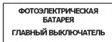
Рисунок В.5 — Пример знака на выключателе-разъединителе ФБ (главном выключателе ФБ) и идентичный знак МЭК
