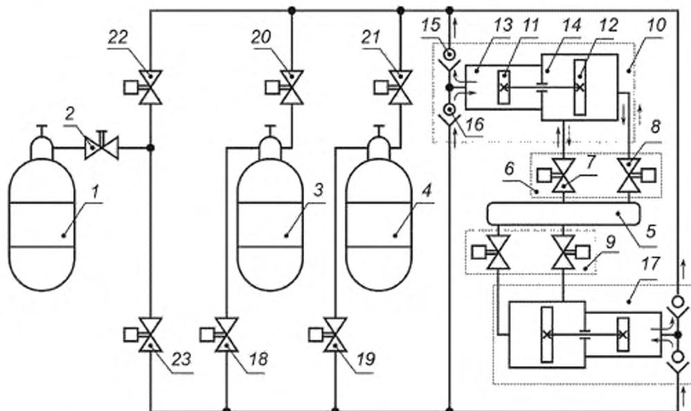
Рисунок 3 — Пневмогидравлическая схема газокompрессорной системы агрегата УКС
