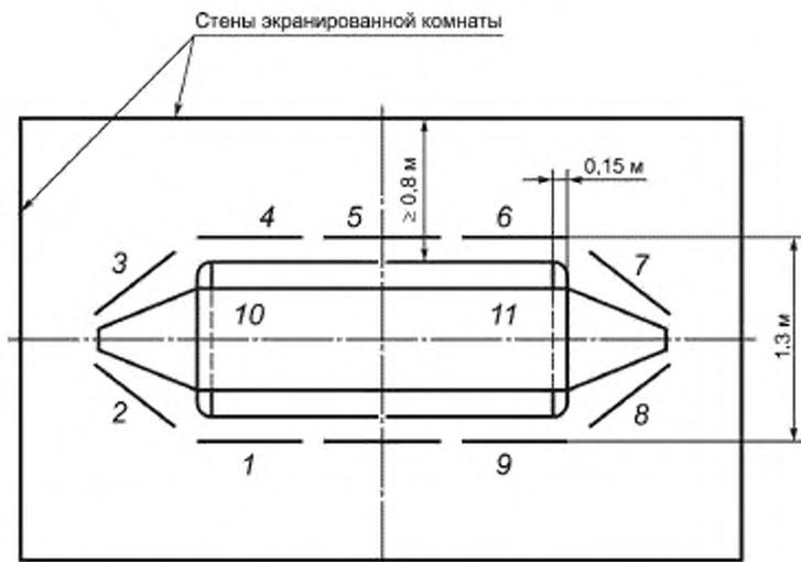
Рисунок 5 — Пример схемы TEM-устройства на базе открытой полосковой линии в комбинации с поглощающими панелями внутри экранированной комнаты размерами 3 × 3,5 м
