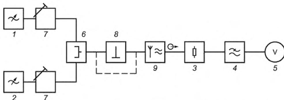
1 — генератор мешающего сигнала G1; 2 — генератор полезного сигнала G2; 3 — нагрузочный резистор  $R_L$ ; 4 — фильтр нижних частот; 5 — вольтметр звуковой частоты (со схемой взвешивания в соответствии с Рекомендацией 468 МККР); 6 — схема связи; 7 — аттенюаторы; 8 — согласующая и/или симметрирующая схема; 9 — испытуемое оборудование (ИО)
