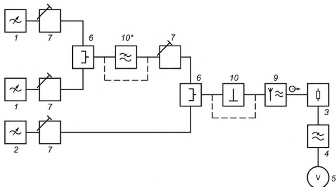
1 — генераторы мешающего сигнала G1; 2 — генератор полезного сигнала G2; 3 — нагрузочный резистор  $R_L$ ; 4 — фильтр нижних частот; 5 — вольтметр звуковой частоты (со схемой взвешивания в соответствии с Рекомендацией 468 МККР); 6 — схемы связи; 7 — аттенюаторы; 8 — согласующая и/или симметрирующая схема; 9 — испытуемое оборудование; 10 — фильтр нижних частот\*
