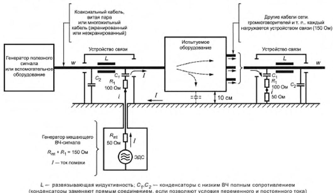
Рисунок 2 — Общий принцип метода инъекции тока
