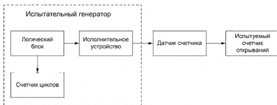
Рисунок В.1 — Блок-схема испытательного генератора
