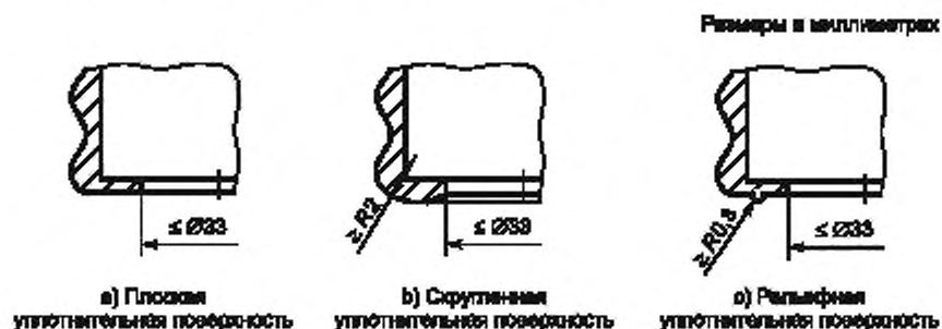
Рисунок 2 — Уплотнительная поверхность соединителя с наружной резьбой
