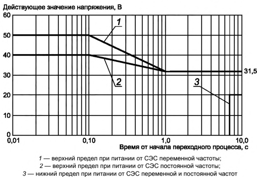
Рисунок 12 — Пределы приведенных значений ненормальных повышенных и пониженных напряжений вторичных систем постоянного тока 27 В
