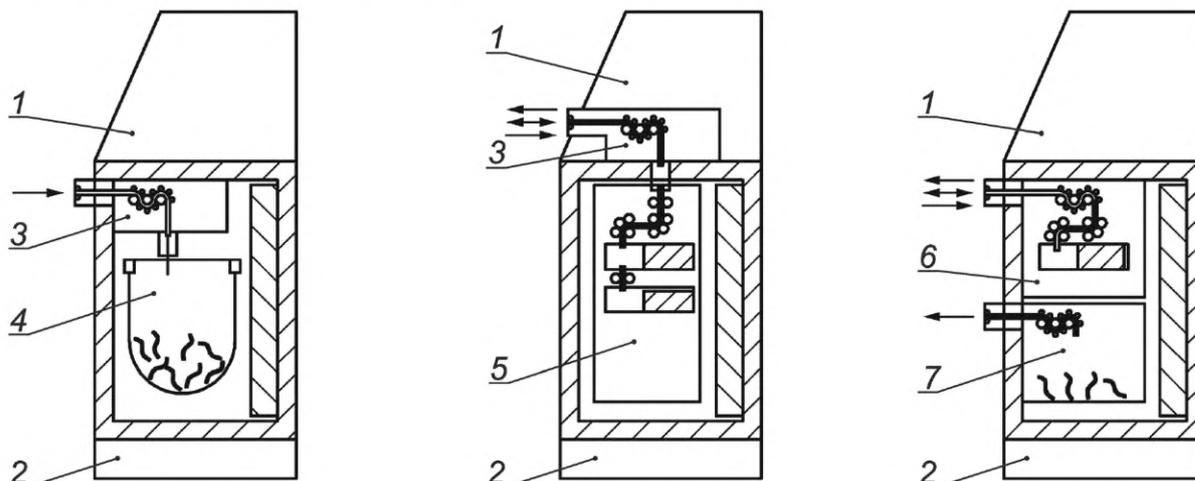
1 — блок управления банкомата; 2 — основание банкомата (опционально); 3 — механизм банкомата для подсчета; 4 — место хранения; 5 — механизм банкомата для безопасной транспортировки и хранения; 6 — механизм банкомата для безопасной транспортировки и хранения с возможностью подсчета; 7 — контейнер для депозитов
