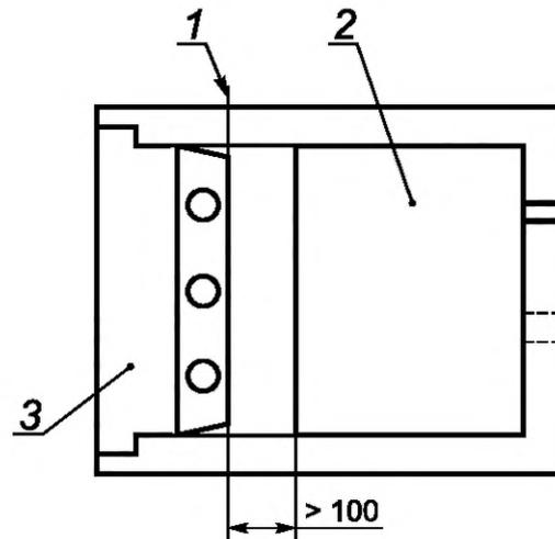
1 — плоскость крышки, закрывающей ригельный механизм; 2 — воздействующие инструменты не должны попадать во внутренний объем, обозначенный затененной областью; 3 — дверь
