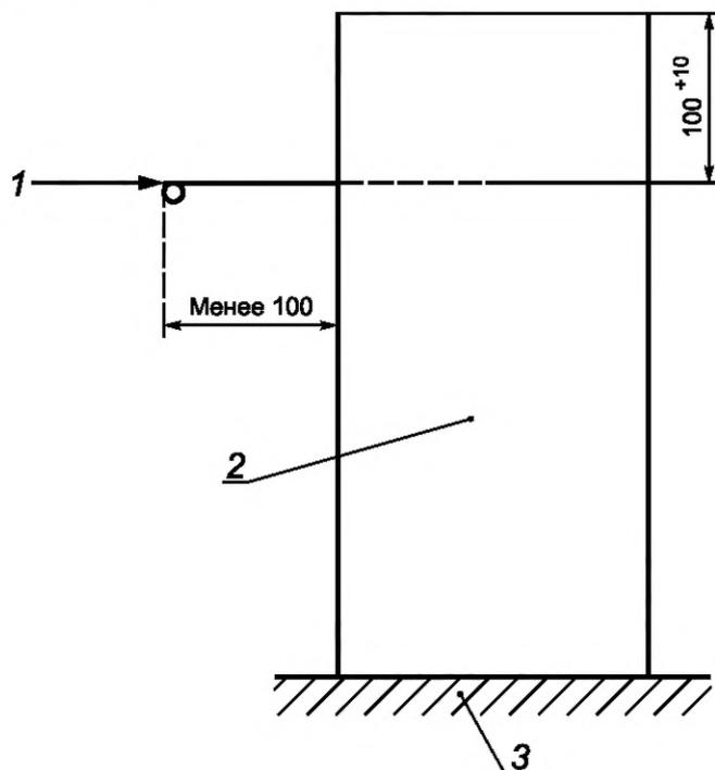
1 — направление прикладываемой нагрузки; 2 — образец для испытания;
