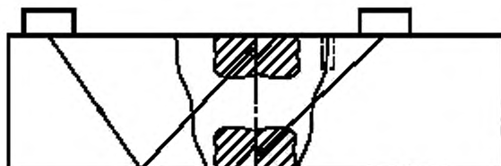
Рисунок 8 — Настройка по угловым отражателям
