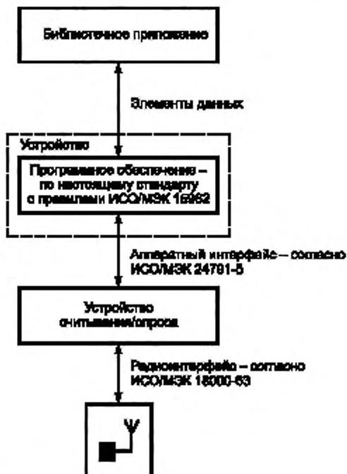
Рисунок 2 — Архитектура с интегрированными программными компонентами
