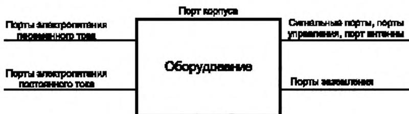
Рисунок 1 — Примеры портов оборудования
