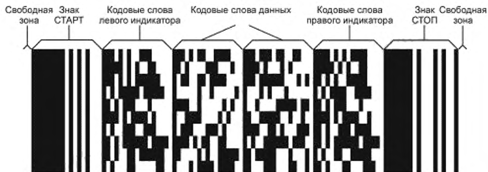
Рисунок 1 — Структура символа PDF417
