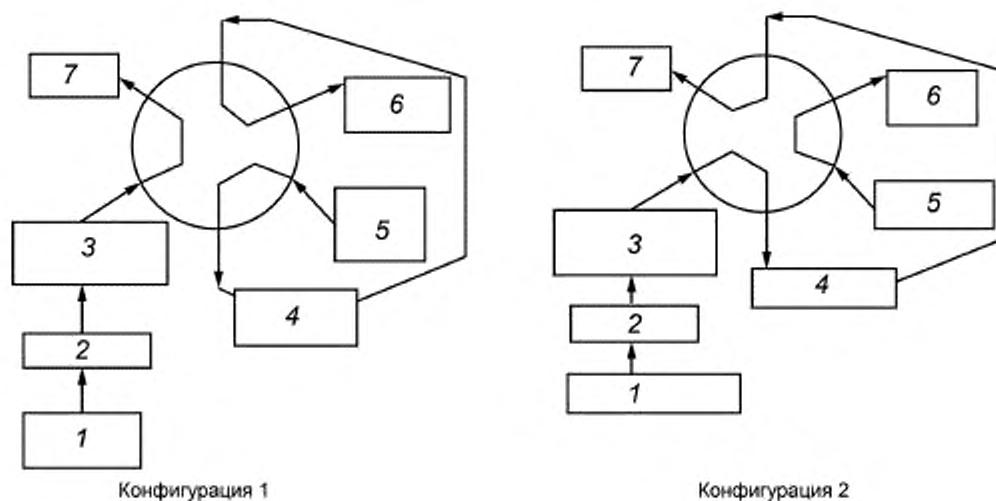
1 — изократический насос; 2 — автосамплер; 3 — аналитическая эксплюзионная колонка; 4 — аналитическая колонка C18.
