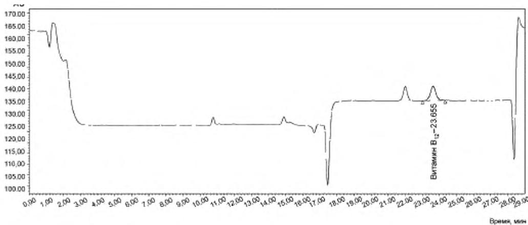
Рисунок А.2 — Типичная хроматограмма раствора пробы
