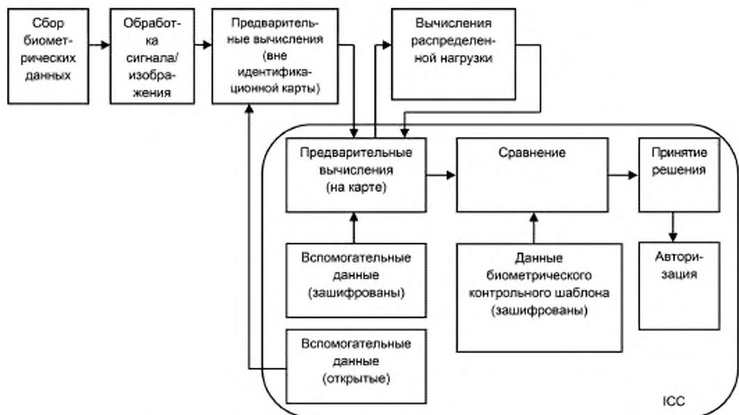
Рисунок 3 — Общая архитектура для биометрического распознавания с распределением нагрузки
