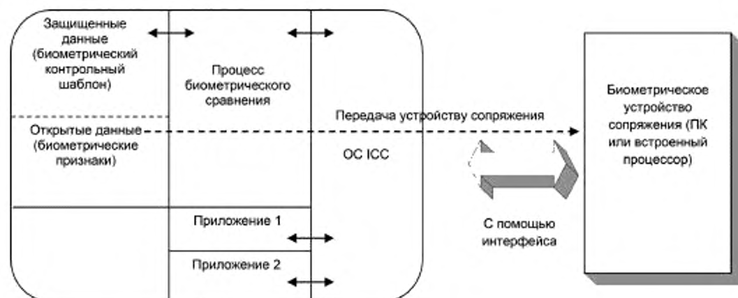
Рисунок G.1 — Блок-схема биометрического сравнения на идентификационной карте с распределением нагрузки (техническая поправка Cor 1:2013)
