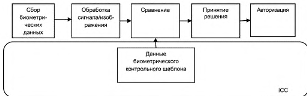
Рисунок 1 — Общая архитектура для биометрического распознавания с использованием сравнения вне идентификационной карты
