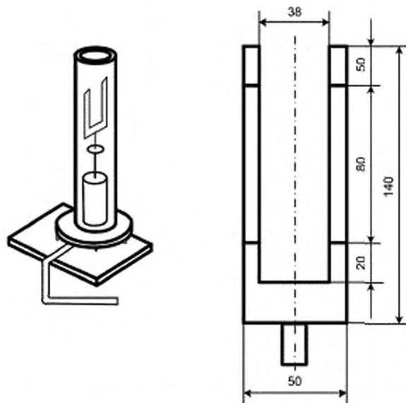
Рисунок 10.2 — Реакционная камера и рамка — держатель образца
