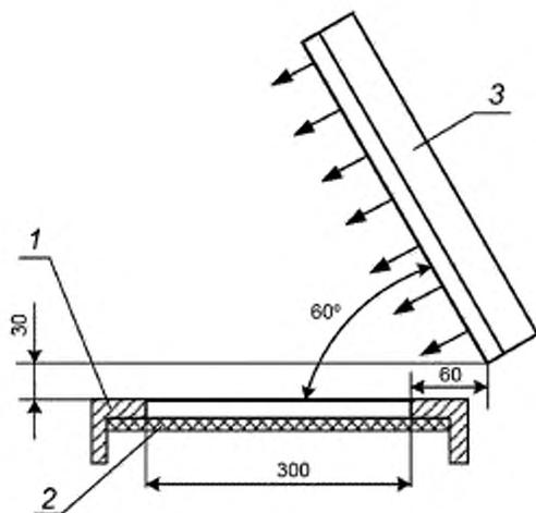
1 — держатель с образцом; 2 — образец; 3 — электрическая радиационная панель
