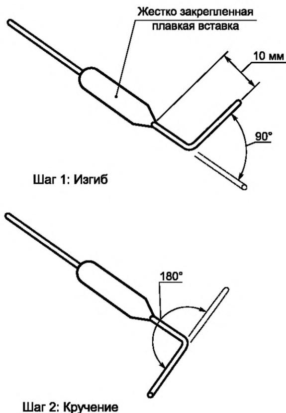
Рисунок 1 — Изгибающая/скручивающая сила
