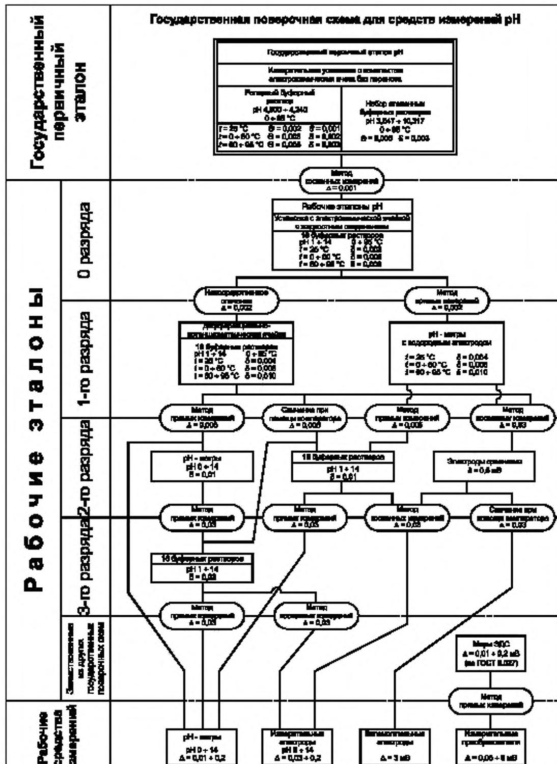
3.3.3 16 буферных растворов (рабочие эталоны рН 2-го разряда) применяют для поверки рабочих рН-метров методом прямых измерений и измерительных электродов методом косвенных измерений.
