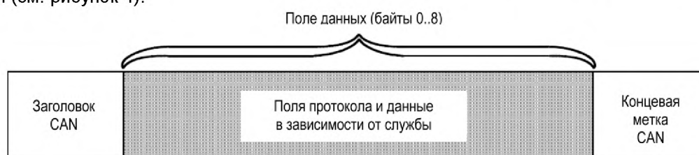
Рисунок 4 – Использование поля данных явного сообщения CAN
