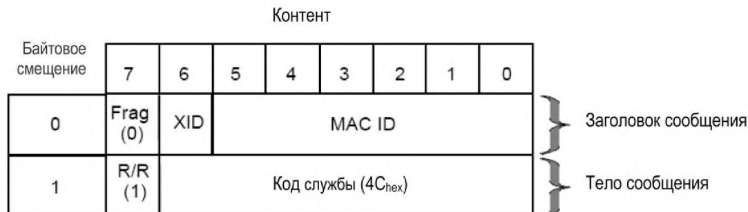
Рисунок 11 – Формат отклика на отключение соединения
