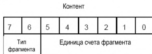
Рисунок 17 – Формат протокола фрагментации DeviceNet
