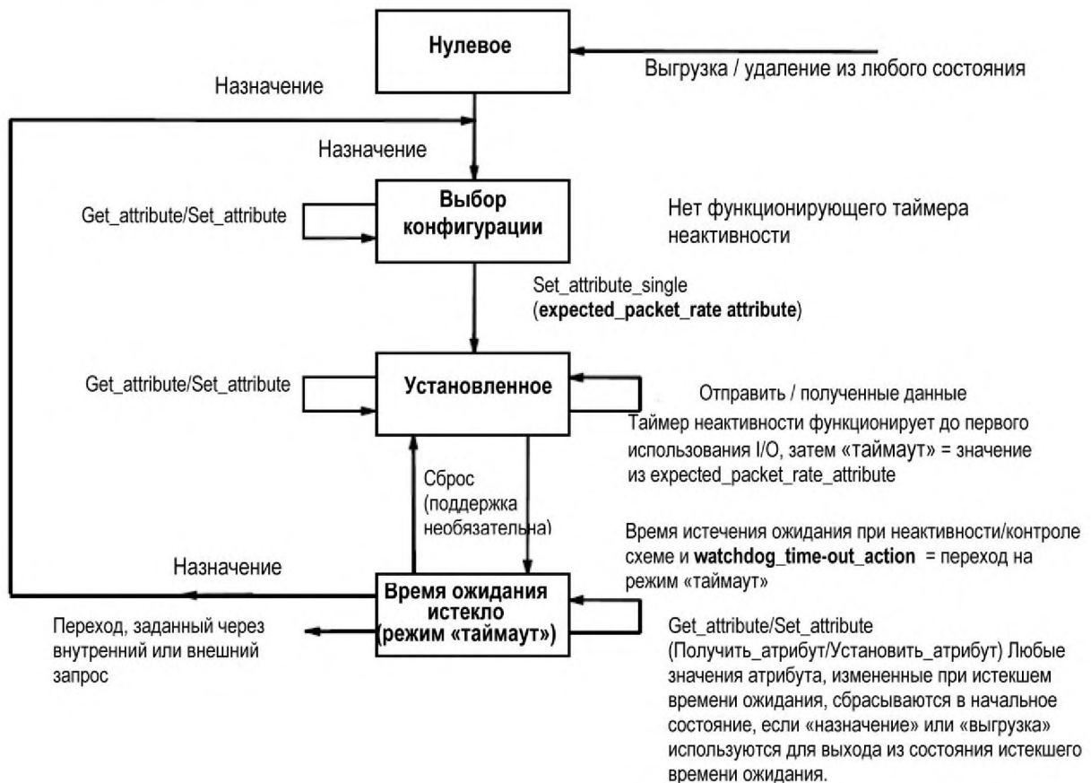
Рисунок 45 – Схема передачи состояния predetermined соединения I/O ведущего и ведомого устройств
