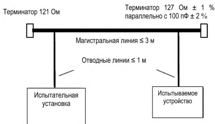
Рисунок 70 – Схема испытания временной выдержки
