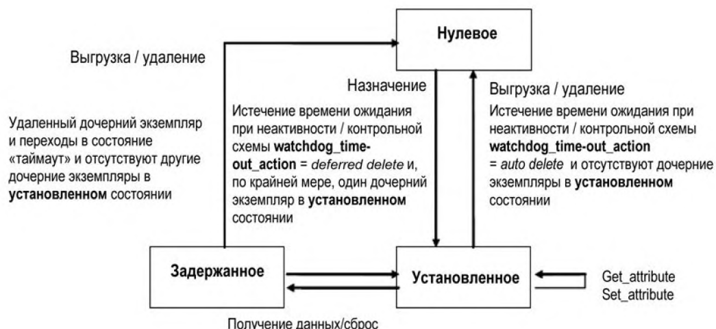
Рисунок 46 – Схема передачи состояния предопределенного соединения ведущего и ведомого устройства для передачи явных сообщений
