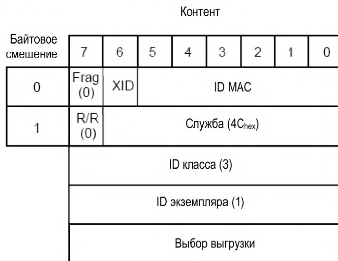
Рисунок 43 – Сообщение-запрос на release_master/slave_connection_set
