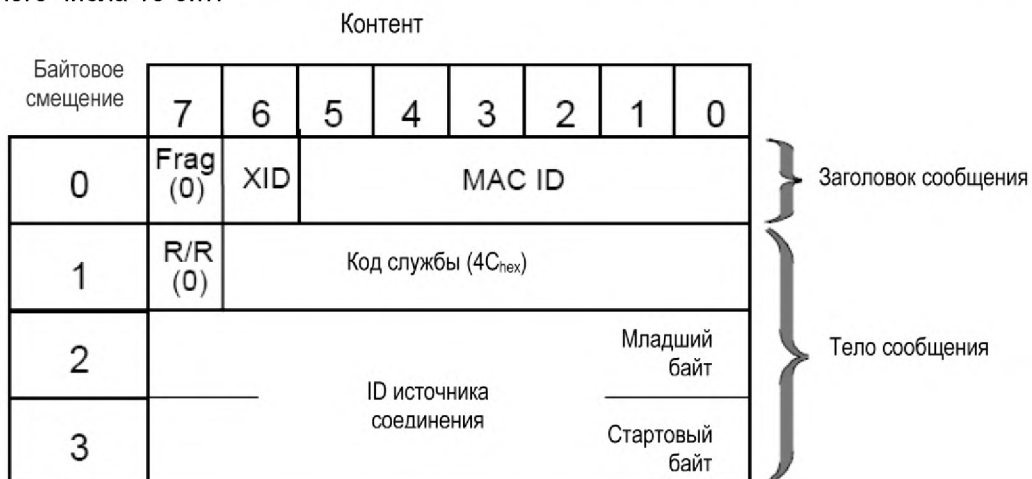
Рисунок 10 – Формат запроса на отключение соединения
