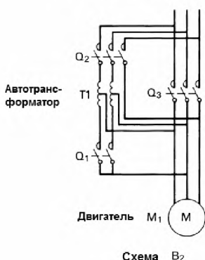
Рисунок 5 – Типичные способы и схемы пуска асинхронных двигателей переменного тока при помощи автотрансформаторов, лист 1
