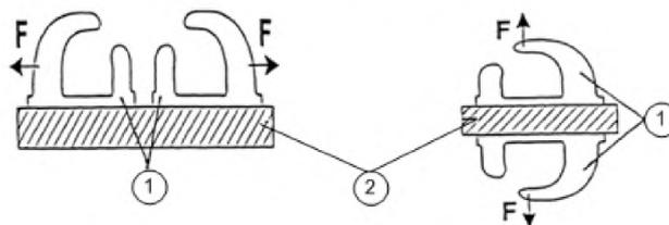
а) испытание в направлении вертикальной нагрузки    б) испытание перпендикулярно вертикальной нагрузке
