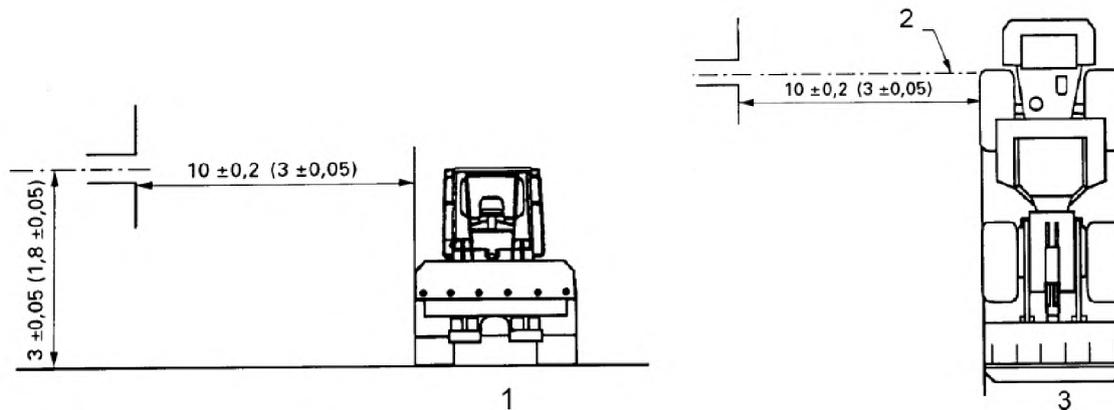
а) расположение дипольной антенны в положении для измерения излучения с вертикальной поляризацией
