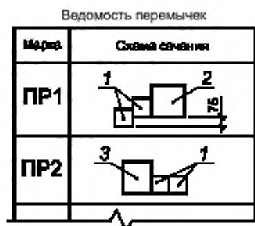
Рисунок В.1 — Пример выполнения ведомости перемычек
