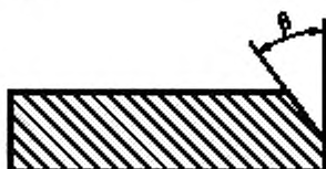
Рисунок Г.4 — Схема измерений угла скоса кромок \beta
