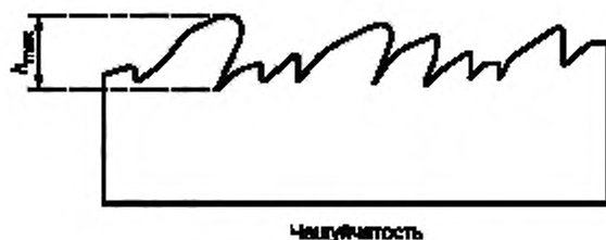
Рисунок А.35 — Чешуйчатость сварного шва
