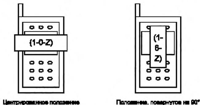
Рисунок 3 — Положения измерения для считывателя eMRTD типа M
