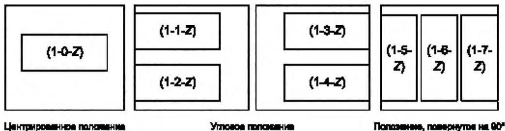
Рисунок 2 — Положения измерения для считывателя eMRTD типа 2 и 3
