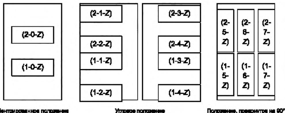
Рисунок 1 — Положения измерения для считывателя eMRTD типа 1
