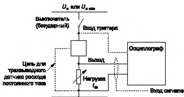
Рисунок 3 — Испытательная цепь для проверки задержки готовности
