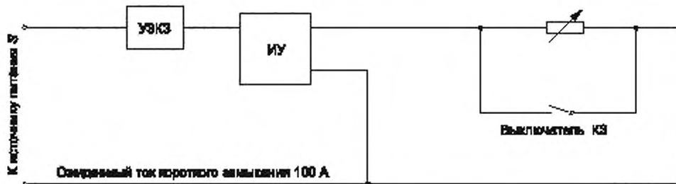
Рисунок 6 — Испытание на короткое замыкание
