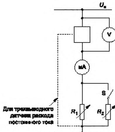
$R_1$  — активная нагрузка;  $R_2$  — активная нагрузка;  $V$  — вольтметр с высоким сопротивлением  $\geq 0,2 \text{ мОм/В}$ ;  $mA$  — миллиамперметр;  $S$  — выключатель
