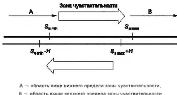
Рисунок 1 — Взаимосвязь между рабочими точками датчика расхода
