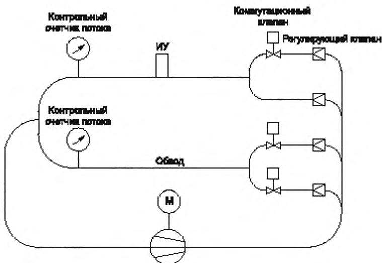
Рисунок 7 — Испытание заданной точки и задержек времени
