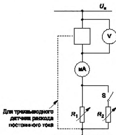
$R_1$  — активная нагрузка;  $R_2$  — активная нагрузка; V — вольтметр с высоким сопротивлением  $\geq 0,2$  Мом/В;
