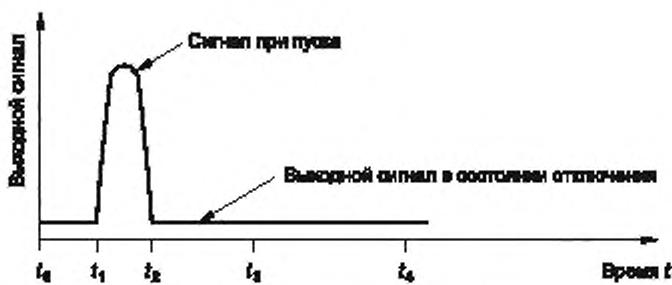
б) Коммутационный элемент в состоянии отключения
