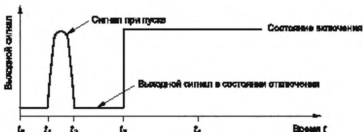
а) Коммутационный элемент в состоянии включения
