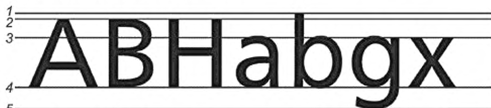
1 — линия самого верхнего выносного элемента; 2 — высота заглавной буквы; 3 — х-высота; 4 — базовая линия; 5 — линия самого нижнего выносного элемента
