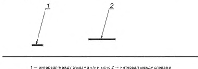
Рисунок 10 — Интервал между словами относительно интервала между знаками
