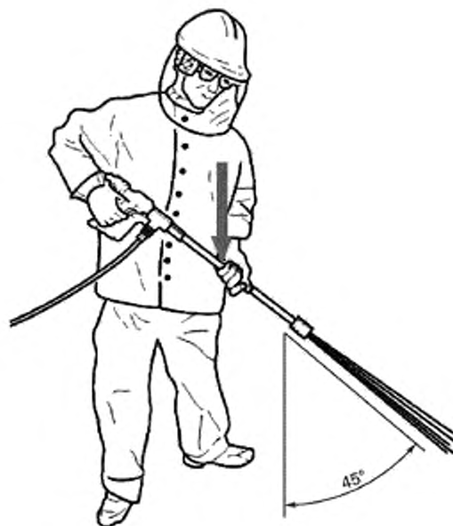
Рисунок DD.5 — Рабочие условия. Положение пистолета-распылителя
