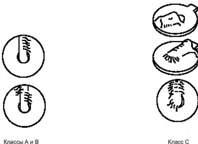
Примечание — Соединение может иметь одну или две галтели, по длине 75 % перекрытия вывода на контактной площадке.
