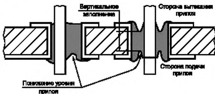
Рисунок 3 — Смачивание припоем выводов и стенок отверстия
