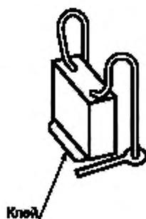
Рисунок А.5 — Торцевой монтаж
