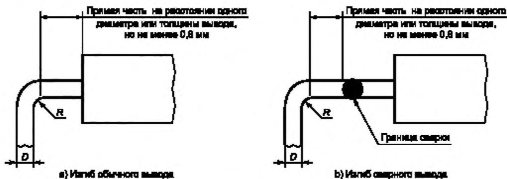
Примечание — Расстояние между выводами для установленных компонентов с обычной формой выводов равно: 7,6 мм — минимальное и 33 мм — максимальное.
