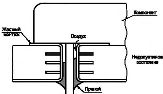
Рисунок 2 — Непропай отверстия
