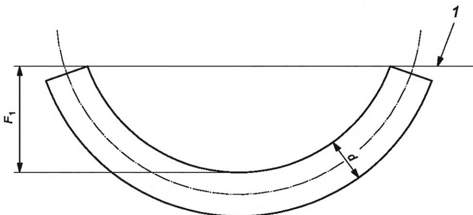
$d$  — толщина испытуемого образца;  $F_1$  — вертикальный прогиб; 1 — линия отсчета
