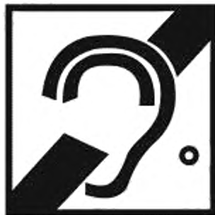
Рисунок 4 — Пиктограмма с символом индукционной петли
