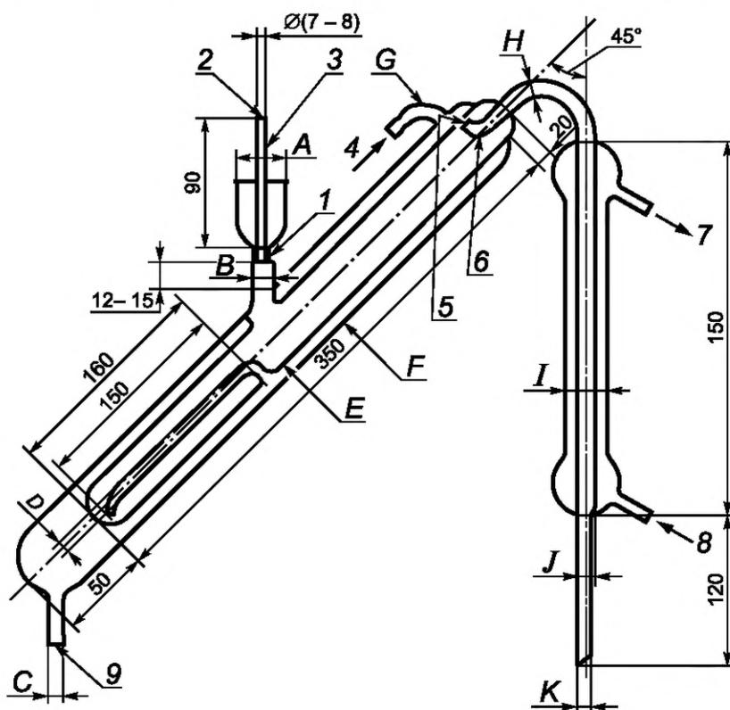
1 — стеклянное притертое соединение; 2 — пробка; 3 — стержень; 4 — входное отверстие для пара; 5 — выпускное отверстие диаметром 5 мм; 6 — отверстие диаметром 3 мм; 7 — выходное отверстие для воды; 8 — входное отверстие для воды; 9 — выходное отверстие для пара
