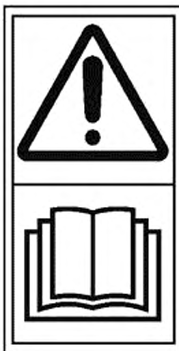
Рисунок ЕЕ.1 — Знак безопасности, обозначающий: «ПРЕДУПРЕЖДЕНИЕ — Ознакомьтесь с инструкциями по эксплуатации до начала работы с машиной»
