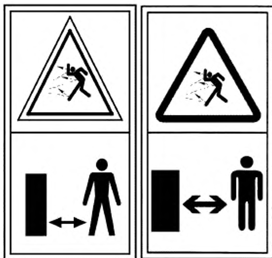
Рисунок EE.4 — Знак безопасности, обозначающий: «ПРЕДУПРЕЖДЕНИЕ — Держитесь на безопасном расстоянии от работающей машины»
