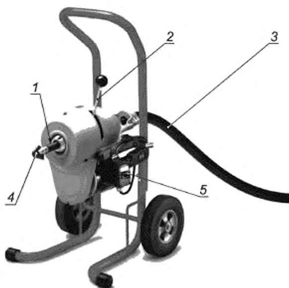
1 — трос для очистки труб; 2 — ручки сцепления; 3 — задний направляющий шланг; 4 — резак, 5 — выключатель питания
