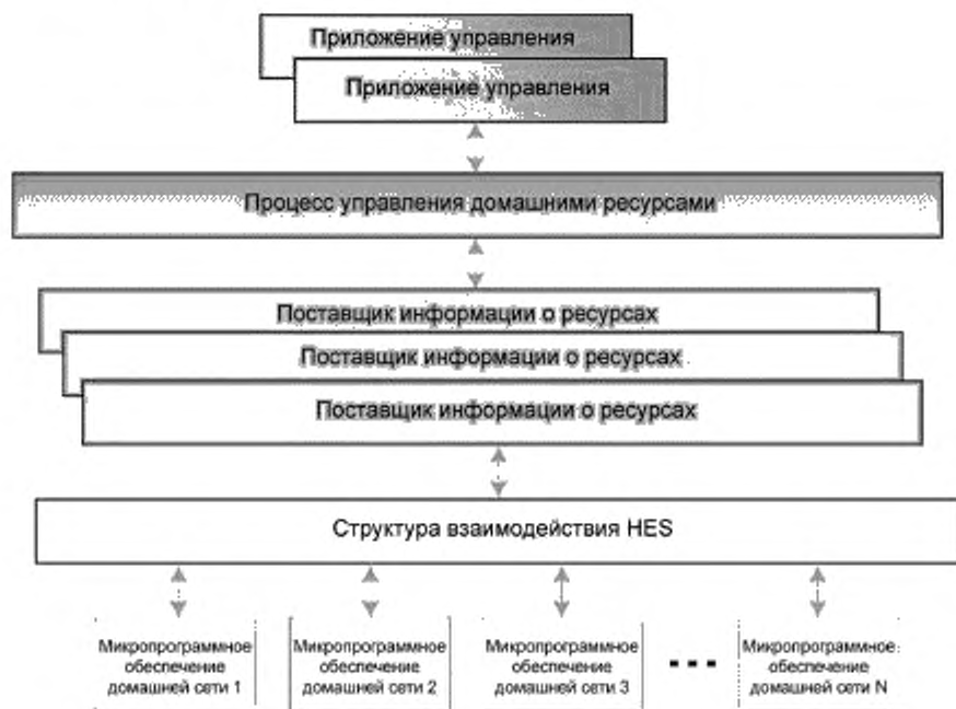
Рисунок 2 — Обзор архитектуры управления домашними сетевыми ресурсами
