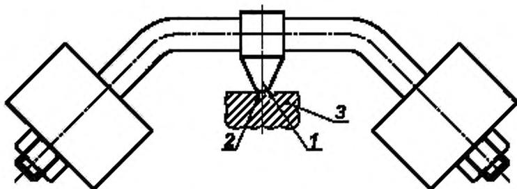
Рисунок G.1 — Устройство для испытания давлением шарика
