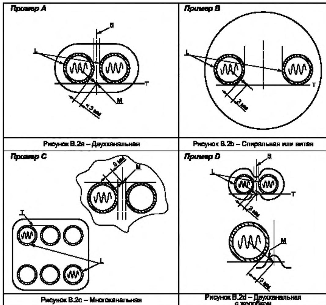
L — каналы, содержащие электроды; T — касательная, S — ось симметрии, M — точка измерения
