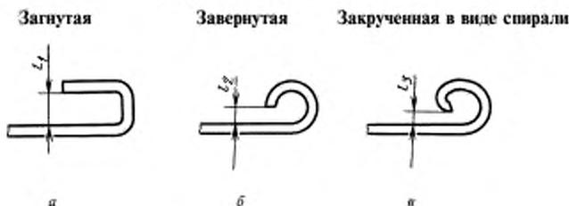
*a* — кромки загнуты на угол менее 270°, максимальный размер  $l_1 = 0,7$  мм, *b* — кромки завернуты на угол от 270° до 360°, максимальный размер  $l_2 = 1,5$  мм; *в* — кромки закручены в виде спирали на угол более 360°, размер  $l_3$  не нормируется
