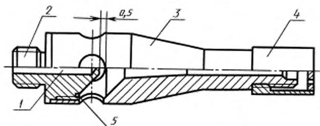
1 — дроссельная трубка; 2 — газовое сопло; 3 — трубка горелки; 4 — стабилизатор пламени;
