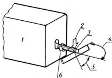
1 — любое устройство, портативное или стационарное, обеспечивающее приложение усилия до 6 Н к шпинделю и поворот шпинделя; 2 — место приложения максимального усилия в 6 Н к оси шпинделя; 3 — однослойная обмотка изоляционной лентой; 4 — угол расположения испытуемой кромки по отношению к шпинделю, равный  $(90 \pm 5)^\circ$ ; 5 — переменный угол для нахождения наиболее неблагоприятного условия; 6 — направление поворота шпинделя в процессе испытания
