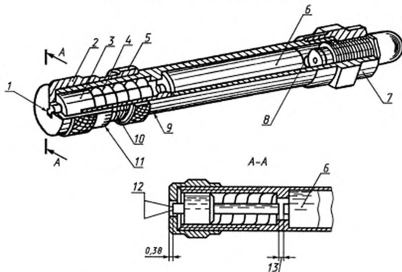
1 — калибровочная щель; 2 — калибровочный колпачок и микрометр; 3 — чувствительная головка; 4 — нагружаемая пружина; 5 — запорное кольцо; 6 — сухой элемент питания R03 или аналогичный химический источник тока; 7 — узел индикаторной лампы и адаптерная гайка; 8 — пружина электрического контакта; 9 — барабан; 10 — эталонная калибровочная отметка; 11 — шкала микрометра; 12 — испытуемое острие; 13 — место контакта чувствительной головки с узлом индикаторной лампы
