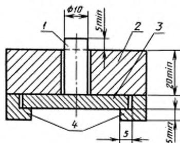
1 — медный цилиндр; 2 — направляющая; 3 — испытываемая деталь; 4 — опоры
