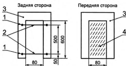
1 — точки фиксирования; 2 — контрольные метки; 3 — пластины держателя;
