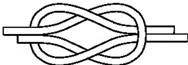
Рисунок 3 — Соединения жил двухпетлевым самозатягивающимся узлом
