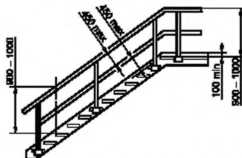
Рисунок 4 — Геометрические параметры защитного ограждения маршевой лестницы
