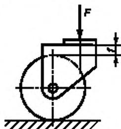
Рисунок 7 — Схема испытания колеса подмости на прочность
