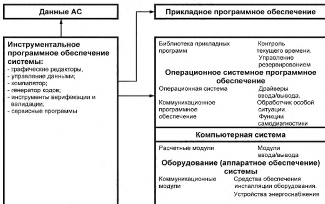
Рисунок 2 — Характерные взаимосвязи между аппаратным обеспечением и программным обеспечением компьютерной системы
