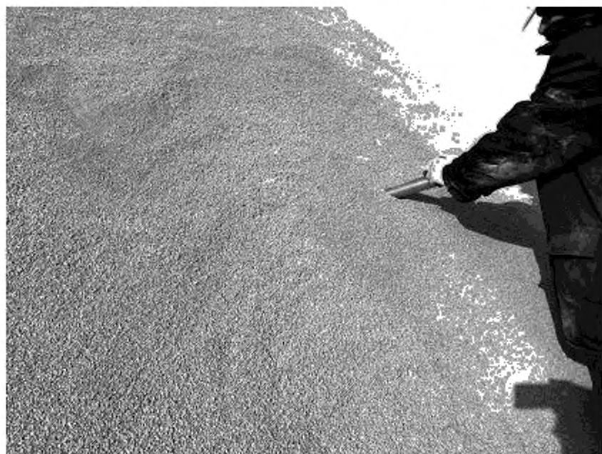
Рисунок 9 — Отбор точечных проб песка пробоотборной трубкой
