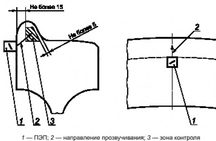
Рисунок А.3 — Схема УЗК гребня цельнокатаных колес эхо-методом F
