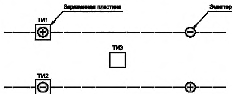
Рисунок 5 — Точки измерений комнатной ионизации. Системы в виде решеток переменного напряжения и шин постоянного напряжения
