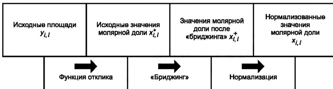
Рисунок В.2 — Блок-схема процесса преобразования данных
