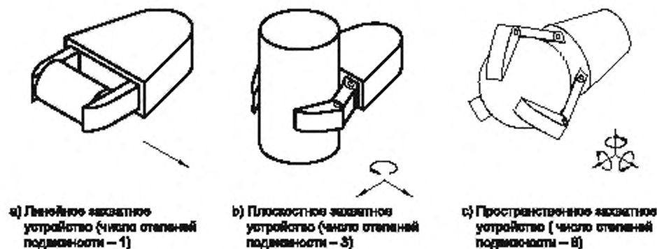
Рисунок 6 — Степени подвижности захватного устройства
