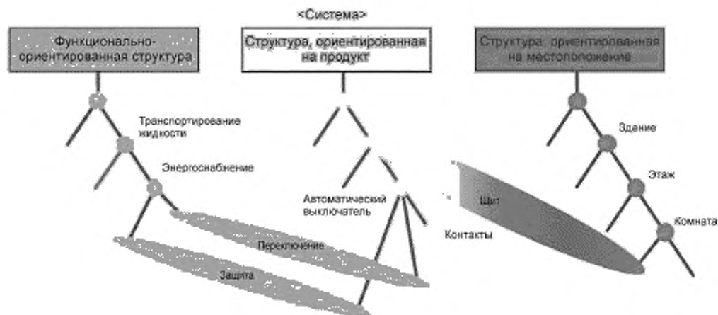
Рисунок С.10 — Структуры с объединенными и общими объектами
