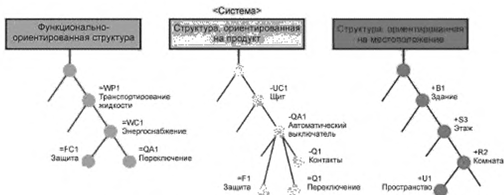
Рисунок С.9 — Структуры с обозначенными подобъектами
