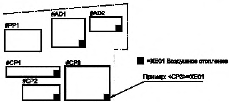
Рисунок 28 — Различные объекты на площадке, указанные с использованием идентификаторов верхнего узла
