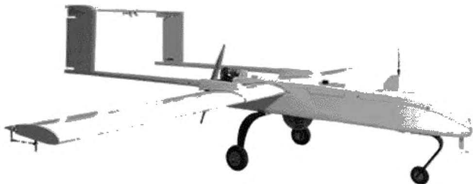
Рисунок 2 — Беспилотное воздушное судно самолетного типа с двигателем внутреннего сгорания
