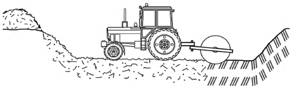
Рисунок А.3 — Операция уплотнения донного слоя грунта котлована сооружения, предназначенного для срочного захоронения трупов, усиленного модификатором свойств грунтов и минеральным вяжущим с помощью катка
